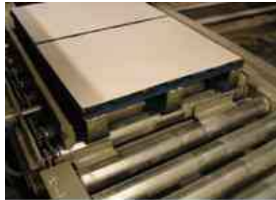
Kartonmagazin mittig geteilt für Deckblatt 600 x 800 mm
