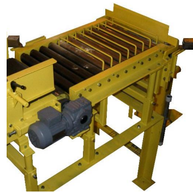
Spezielle Abnehmerrollenbahn für Sackware
